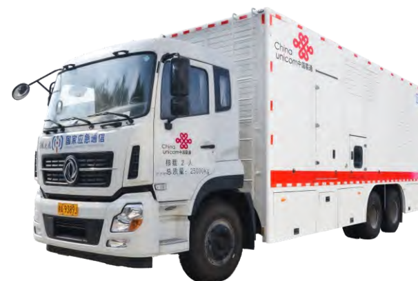
600kW 汽车电站
