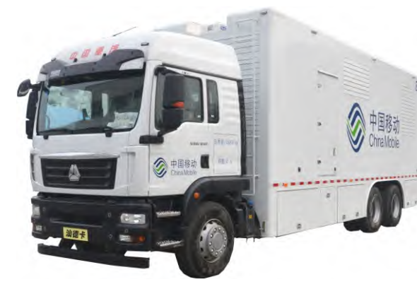
800kW 汽车电站
