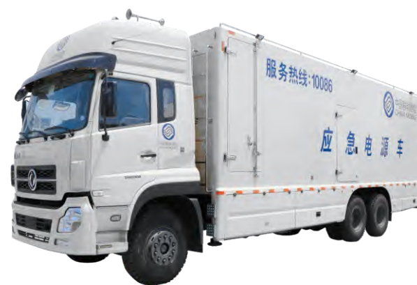
400kW 汽车电站
