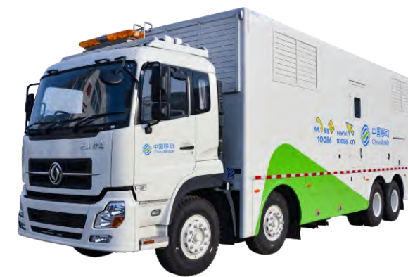
1100kW 汽车电站
